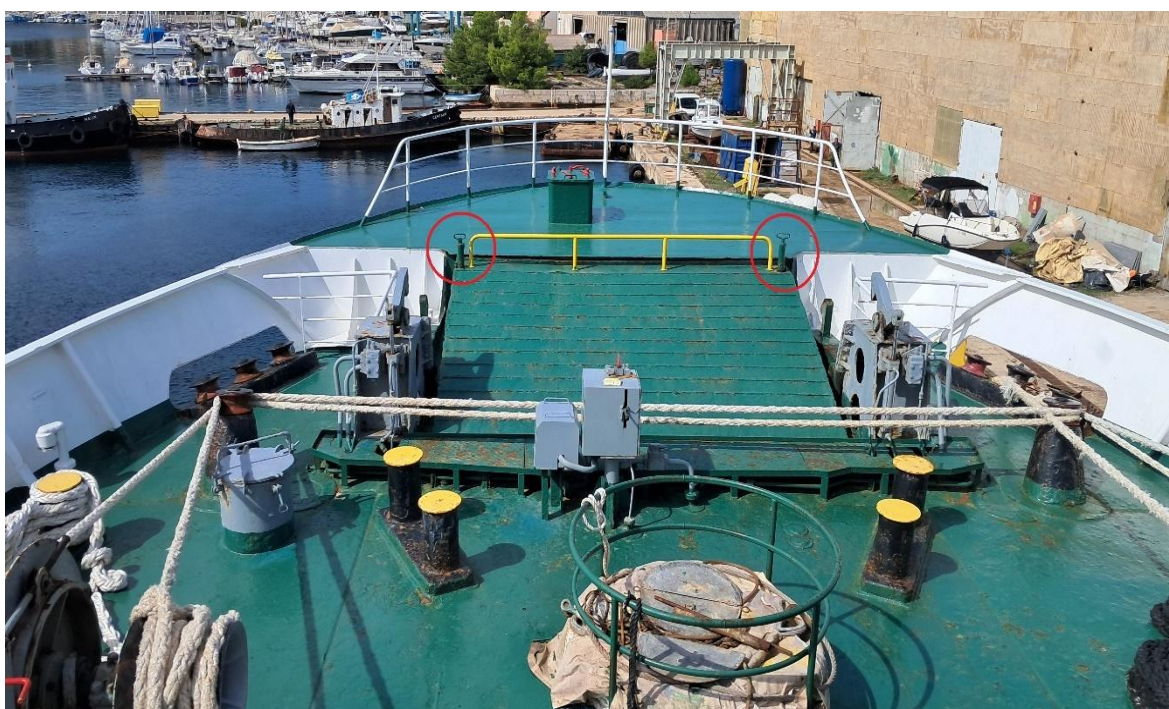
Slika 13. Pogled sa zapovjedničkog mosta - Osigurana pramčana rampa sa spuštenim vizirom (izvor: AIN)
