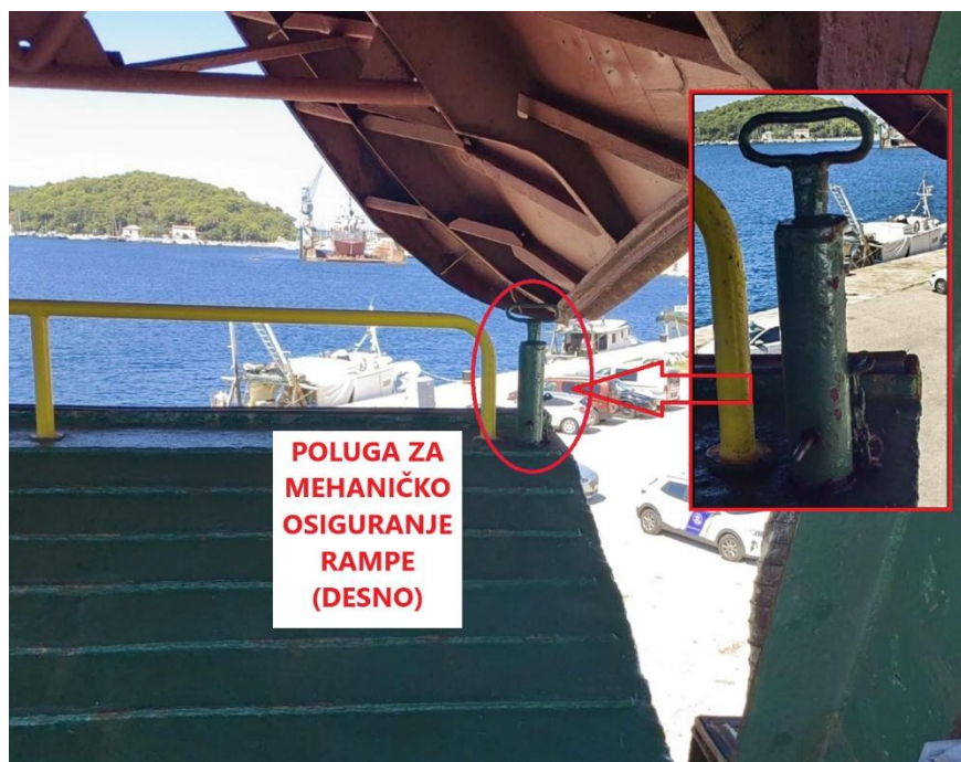
Slika 11. Mehanizam za mehaničko osiguranje pramčane rampe, s istaknutim detaljem – klin (poluga) sa štiftom (prikaz desne strane) (izvor: AIN)
