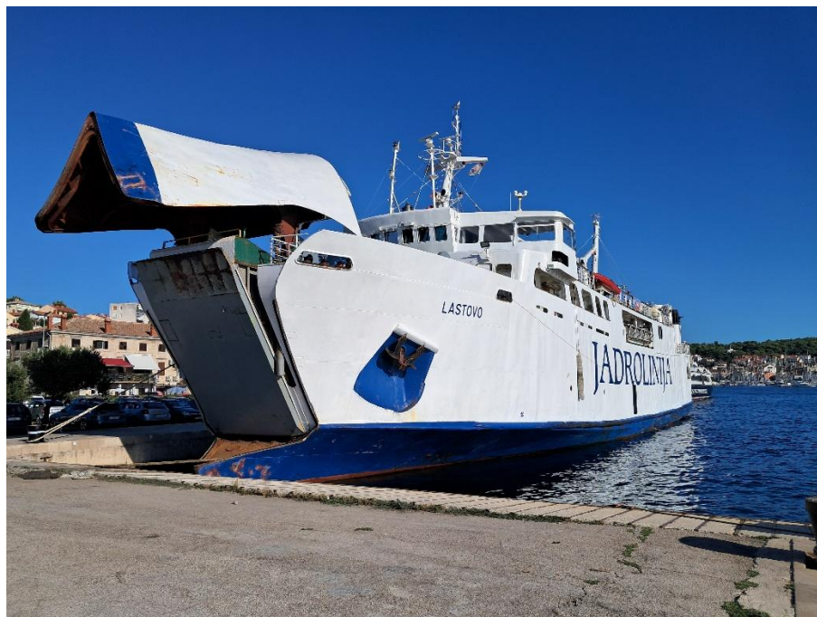
Slika 1. RO-RO putnički brod „Lastovo“ nakon pomorske nesreće, podignuti pramčani vizir i pramčana rampa (izvor: AIN)
