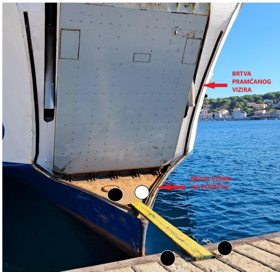
Slika 3. Približni položaj smrtno stradalih pomoraca (crna oznaka) i jednog teško ozlijeđenog pomorca (bijela oznaka) neposredno prije pomorske nesreće; strelice označavaju brtvu pramčanog vizira koja je bila predmet pregleda (izvor: AIN)
