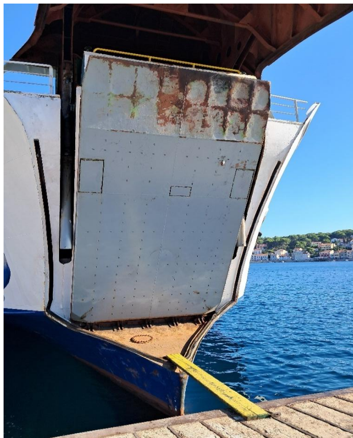
Slika 2. RO-RO putnički brod „Lastovo“ nakon pomorske nesreće, bliži prikaz podignute pramčane rampe i brtve pramčanog vizira (izvor: AIN)
