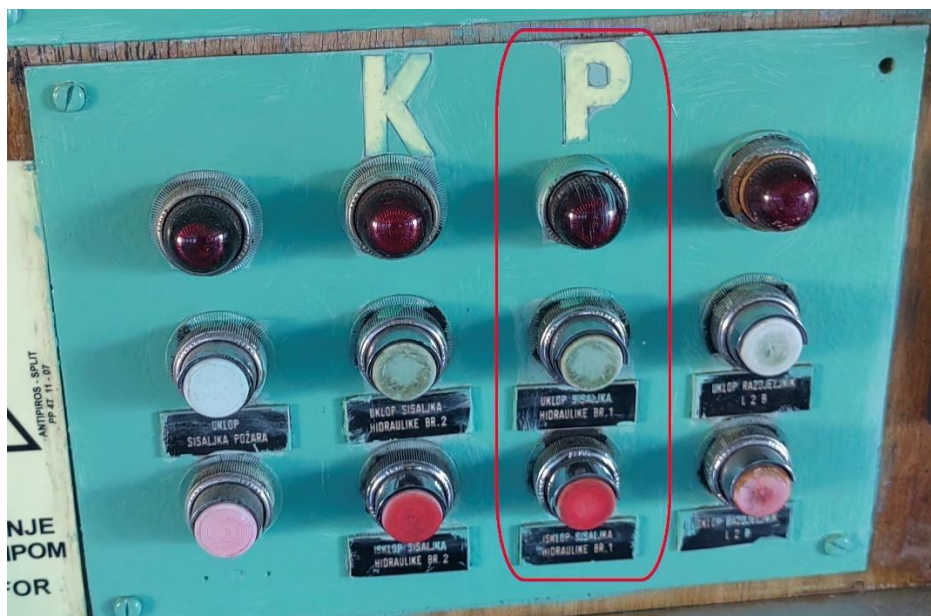
Slika 5. Panel na zapovjedničkom mostu s označenim dijelom za uključivanje i isključivanje hidrauličkog sustava pramčane rampe (izvor: AIN)
