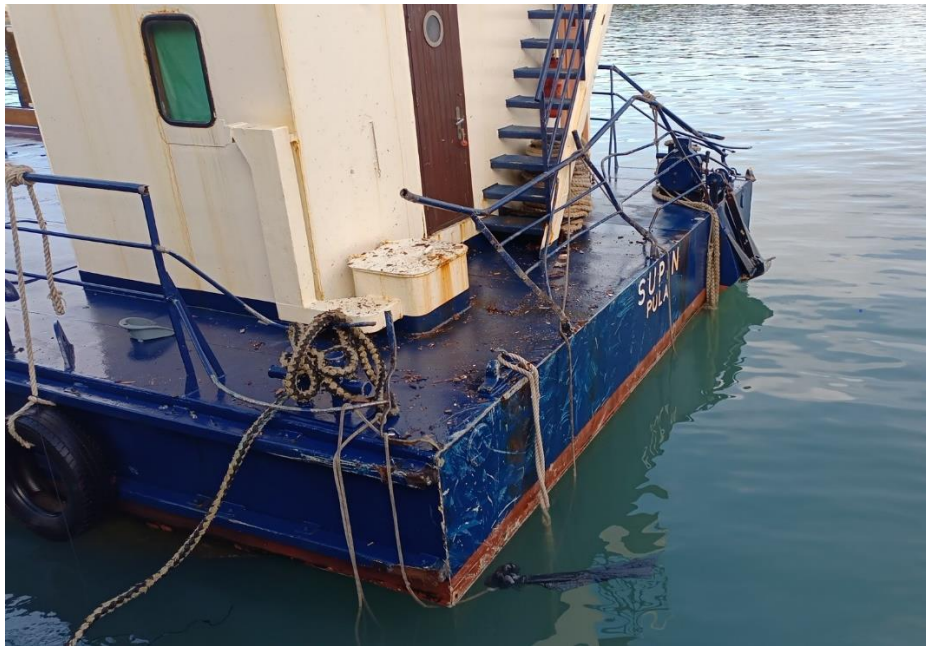
Slika 10. Ro-Ro teretni brod „Supin“, oštećenja kremenog dijela broda (izvor: AIN)
