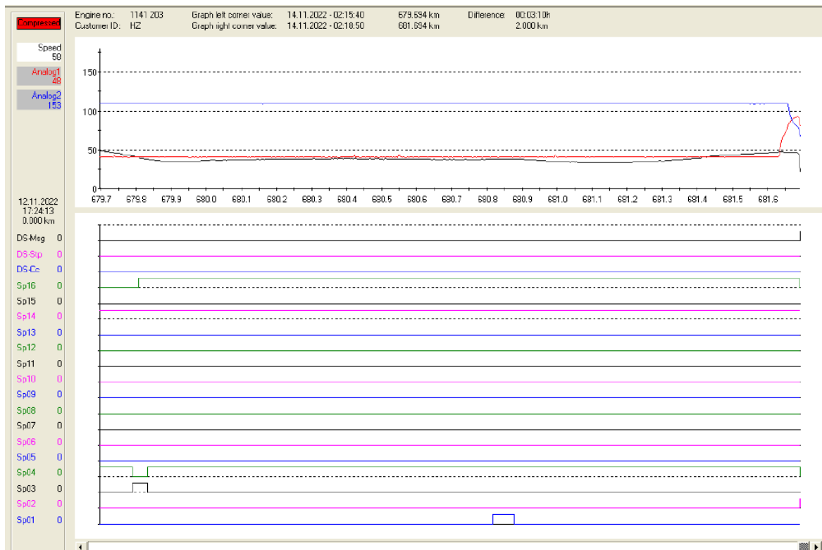
Slika 6. Zapis brzine kretanja vlaka broj 62077 (Izvor slike: HŽ Cargo i AIN)
