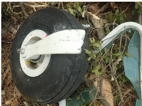
Slika 7 – Puknuta vilica prednjeg stajnog trapa
