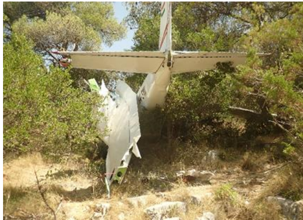
Slika 3 – Savijeno lijevo krilo uz trup zrakoplova
