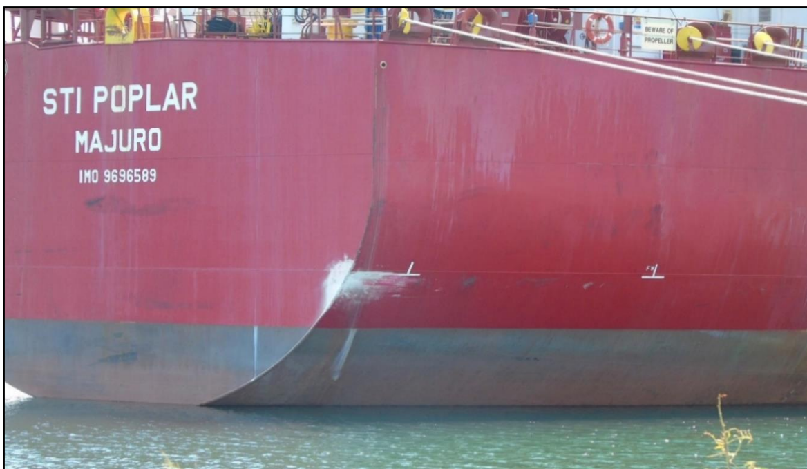
Slika 3. Vidljiva oštećenja vanjske oplata broda nakon udara u pristan tankerskog terminala (izvor: AIN)
