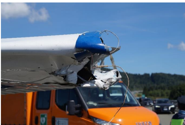
Slika 1 – Oštećenje vrha krila
