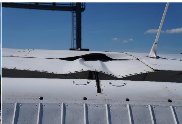
Slika 2 – Oštećenje oplata krila
