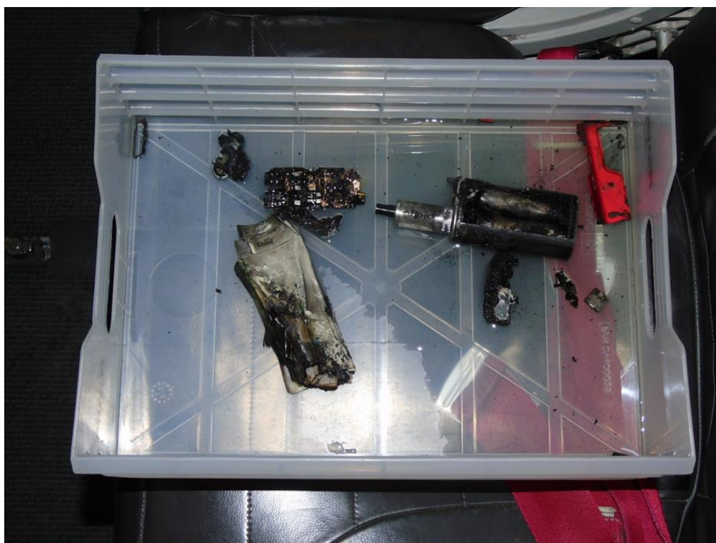
Slika 4 – Elektronski isparivač hlađen u vodi nakon eksplozije
