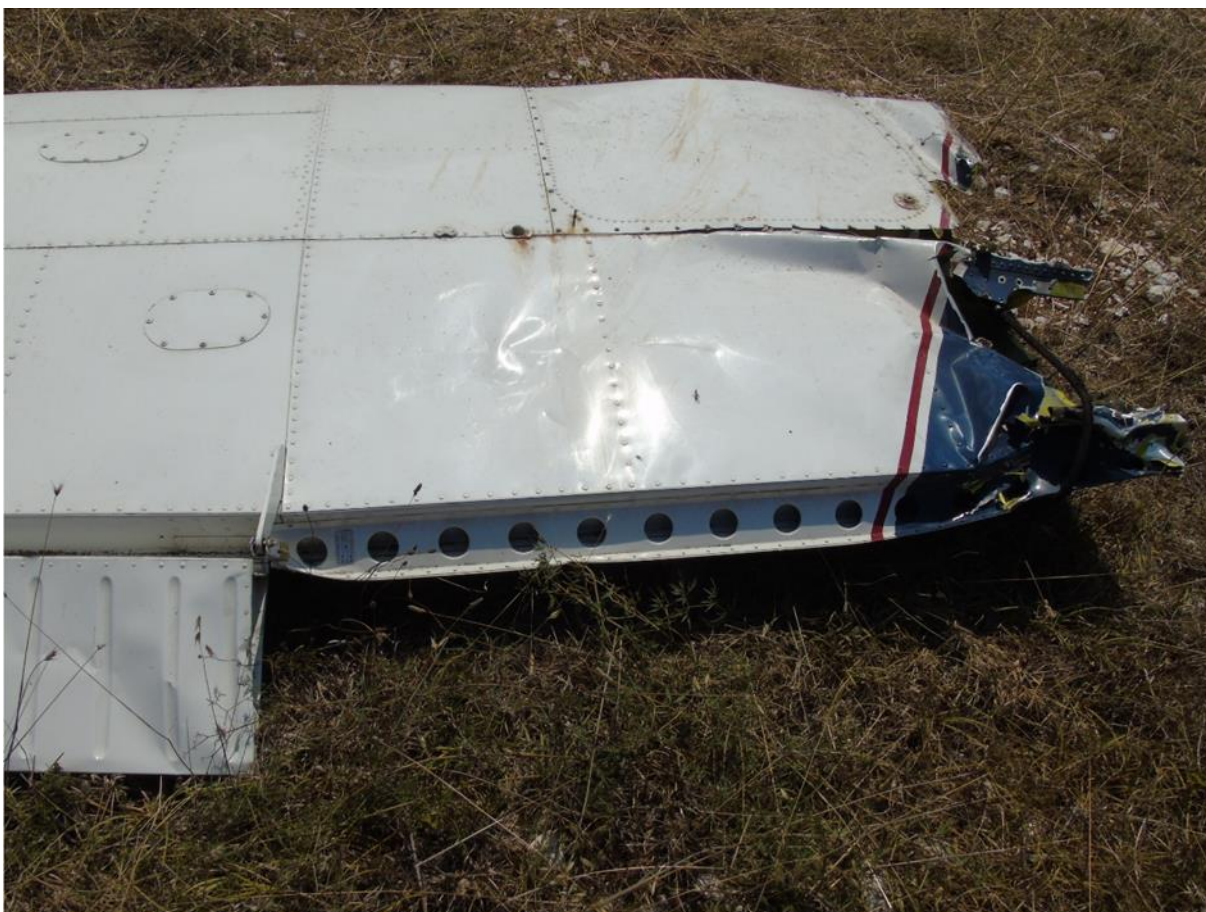
Slika 5 – Oštećenja u korijenu desnog krila predmetnog zrakoplova
