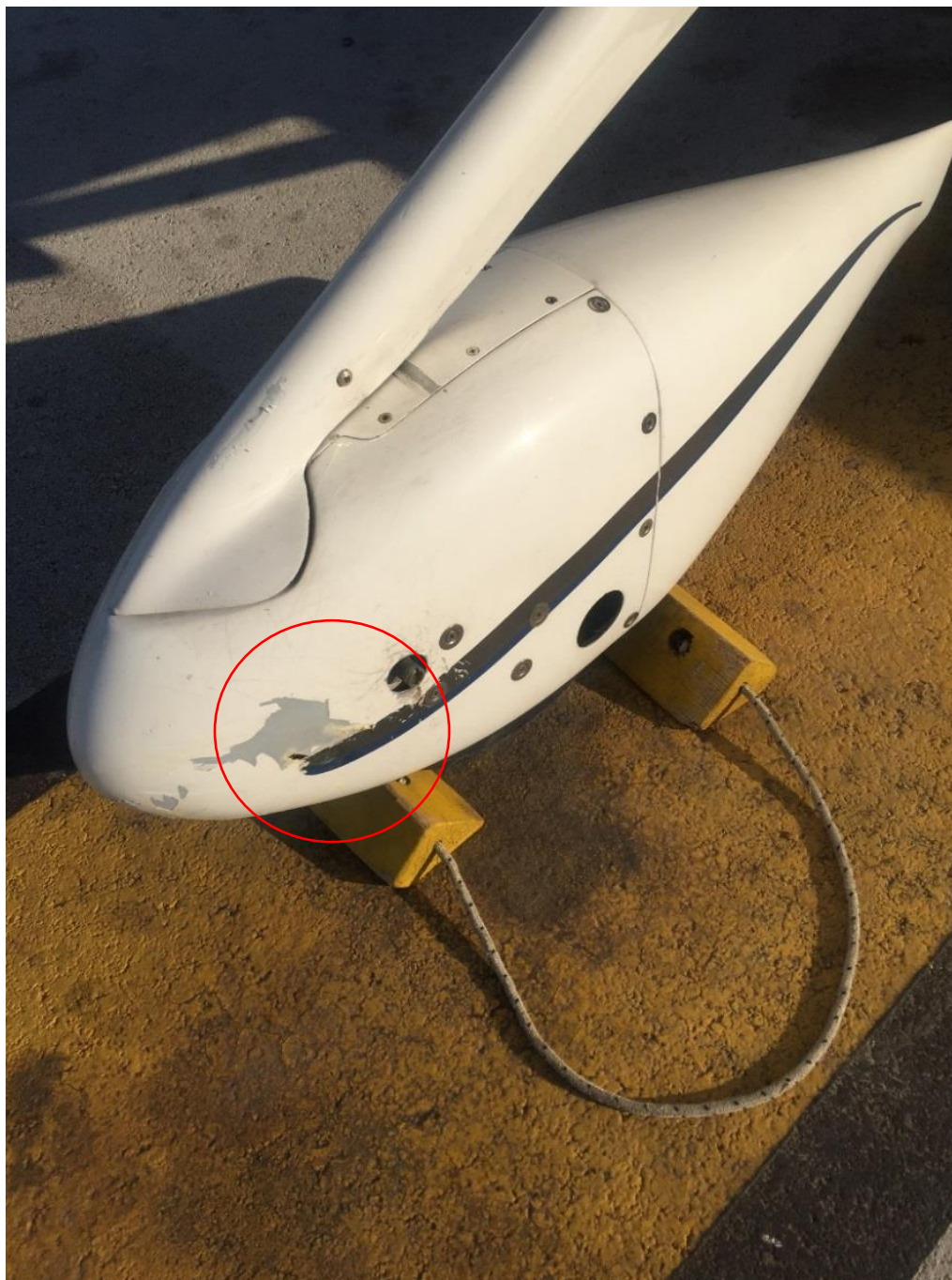
Slika 3. Oštećenje obloge nosnog kotača
