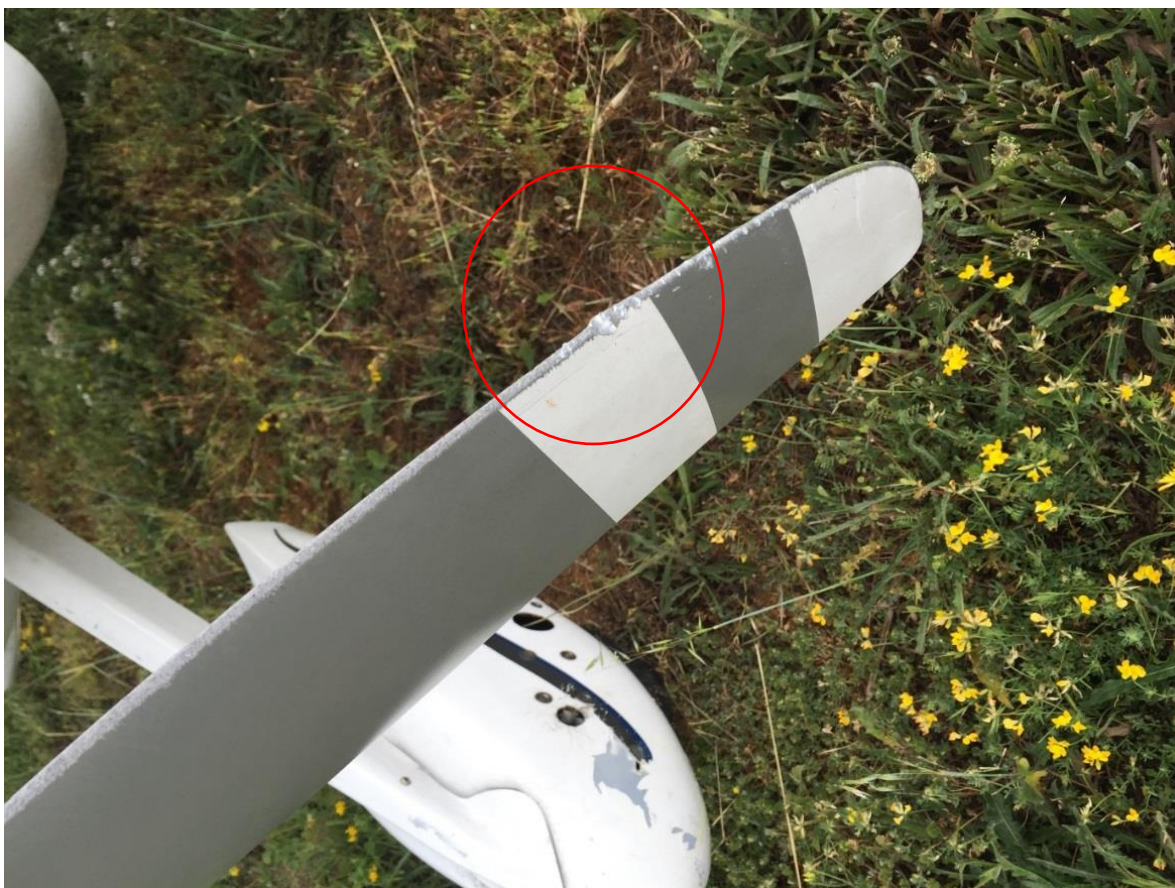
Slika 2. – Oštećeni krak propelera
