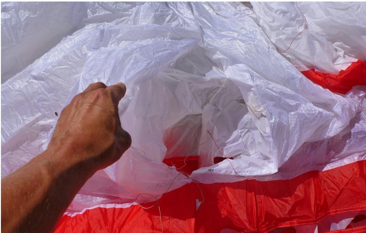
Slika 3. - Oštećenja na kupoli parajedrilice
