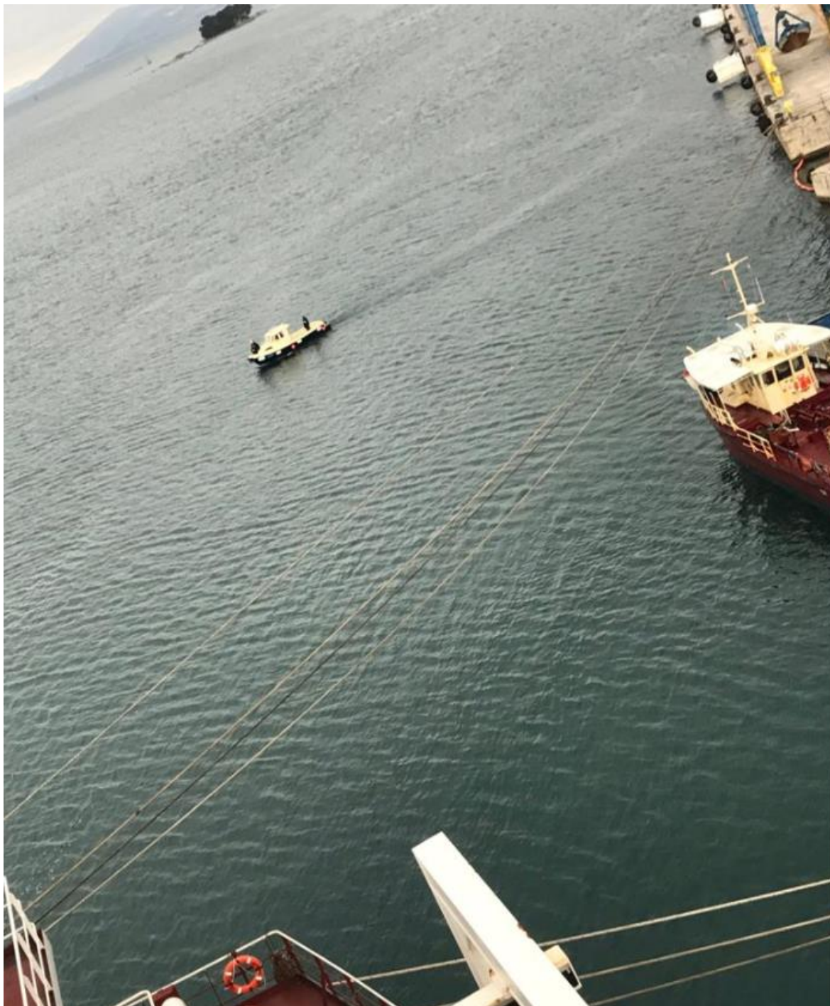
Slika 19. Krmeni konopi broda „Rinella M“ vezani za poler susjednog terminala za cement Sv. Kajo, brod koji je privezan uz bok trajektu za prijevoz cisterni na vezu br. 3 INA tankerskog terminala i otočić Barbarinac vidljivi na fotografiji (izvor: Lučka kapetanija Split)
