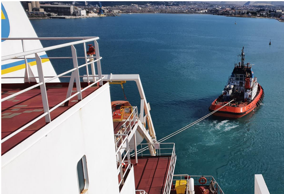
Slika 12. Odsukavanje broda „Rinella M“ – tegljač „Jaki“ privezan po krmi (izvor: Lučka kapetanija Split)
