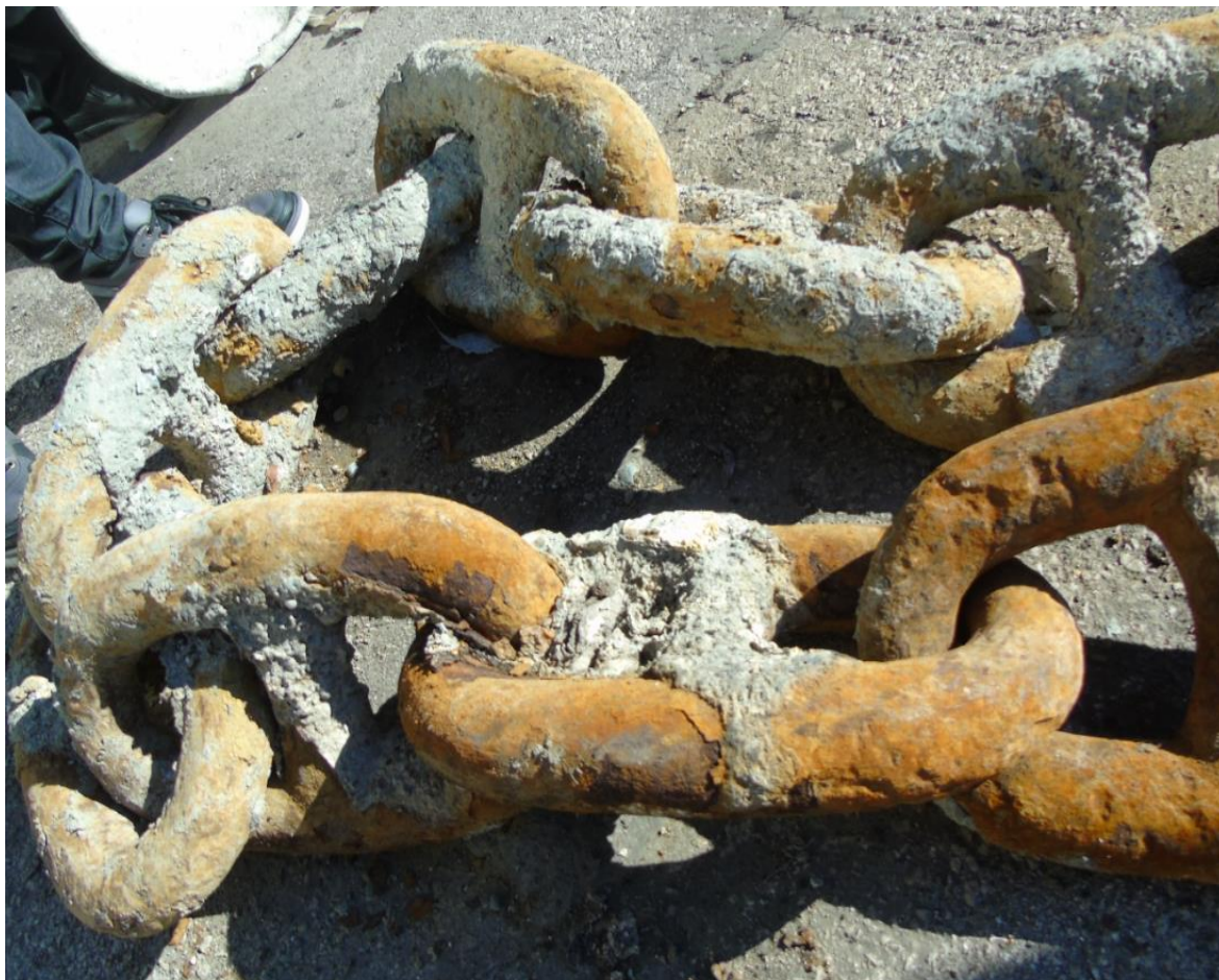
Slika 27. Stariji dio sidrenog lanca kalibra 66 mm s vidljivom naslagom hrđe i obraslina (izvor: AIN)
