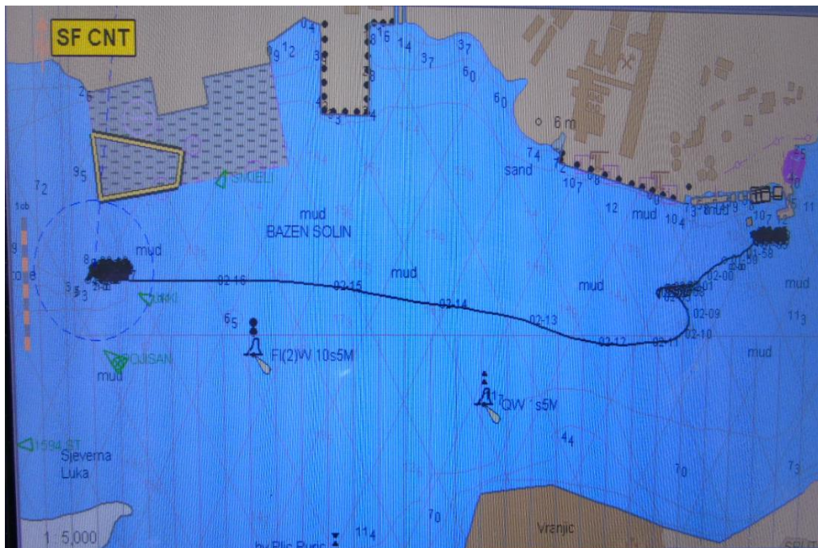
Slika 10. Trajektorija kretanja broda „Rinella M“ od mjesta priveza do pozicije nasukanja, zabilježena na zaslonu brodskog ECDIS-a (UTC vremena)
