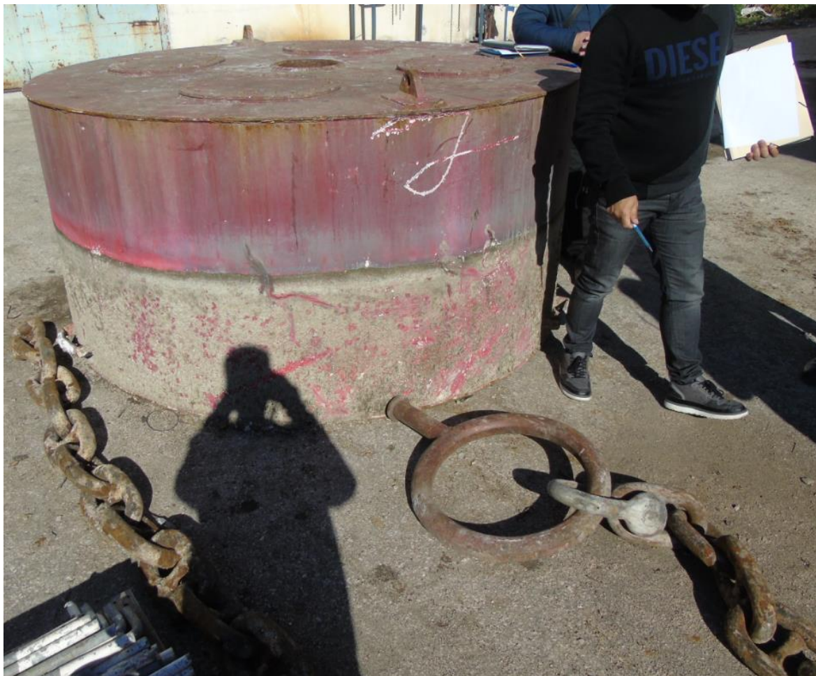
Slika 26. Prsten za prihvat/privez brodskih konopa spojen škopcem na sidreni lanac kalibra 50 mm i privezna plutača (izvor: AIN)
