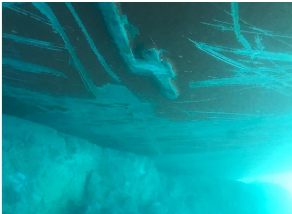
Slika 4. Prikaz dijela oštećenja oplata pramčanog podvodnog dijelu trupa broda (izvor: Lučka kapetanija Split)
