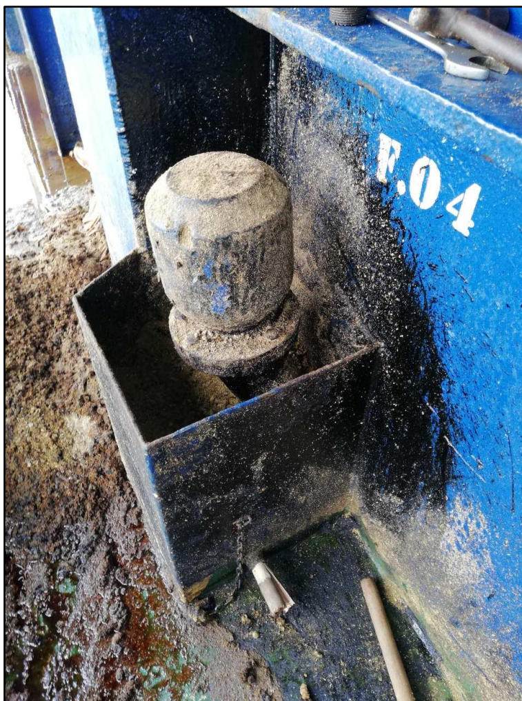
Slika 4. Onečišćenje na palubi broda i odušniku tanka goriva broj 4 (izvor: Lučka kapetanija Pula)
