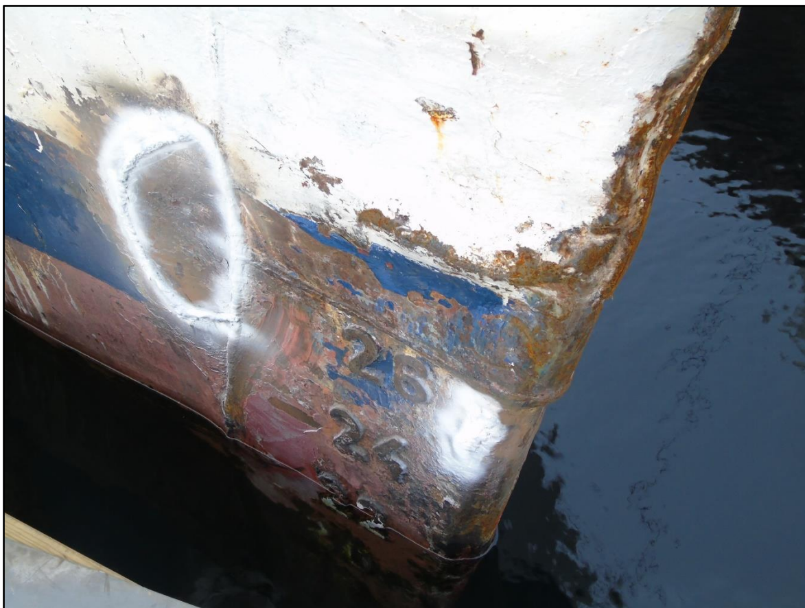
Slika 6. Označena oštećenja na putničkom brodu „Tijat“ (izvor: AIN)
