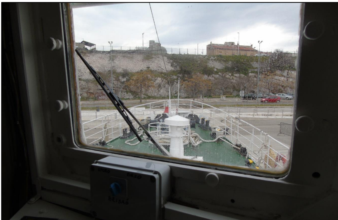
Slika 11. Preglednost prema pramcu s približnog mjesta zapovjednika broda „Tijat“ prije nastanka pomorske nesreće
