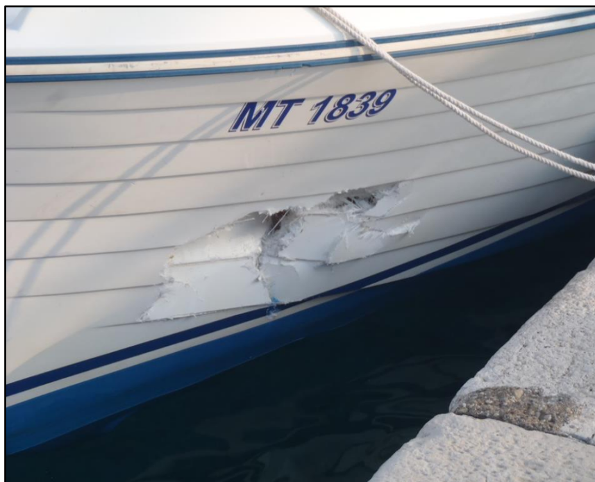
Slika 6. Vidljiva oštećenja pramčanog nadvodnog dijela oplata brodice oznake „MT 1839“ izbliza (izvor: Lučka kapetanija Dubrovnik)
