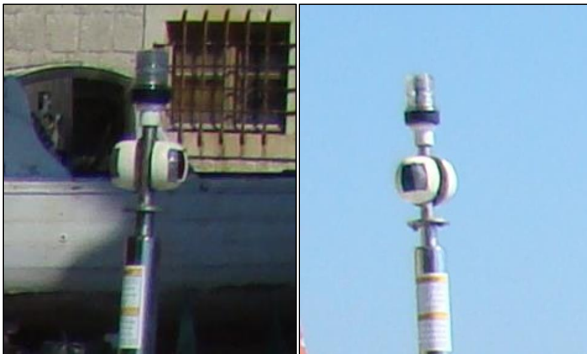
Slika 11. Prikaz preinaka samoljepljivim trakama na navigacijskim svjetlima
