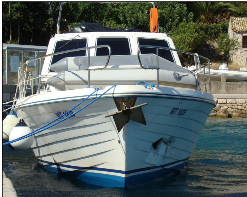
Slika 5. Vidljiva oštećenja pramčanog nadvodnog dijela oplata brodice oznake „MT 1839“
