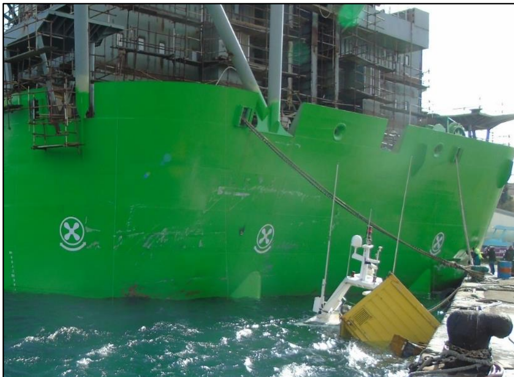
Slika 11. Vidljiva oštećenja na pramčanom (desnom) dijelu platforme uslijed sudara s brodom „Silni“ (izvor: AIN)
