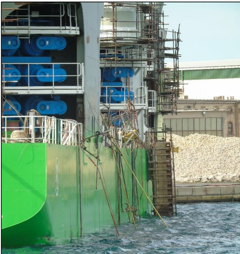
Slika 9. Vidljiva oštećenja na desnom boku platforme uslijed otrgnuća s Obale VIII (izvor: AIN)
