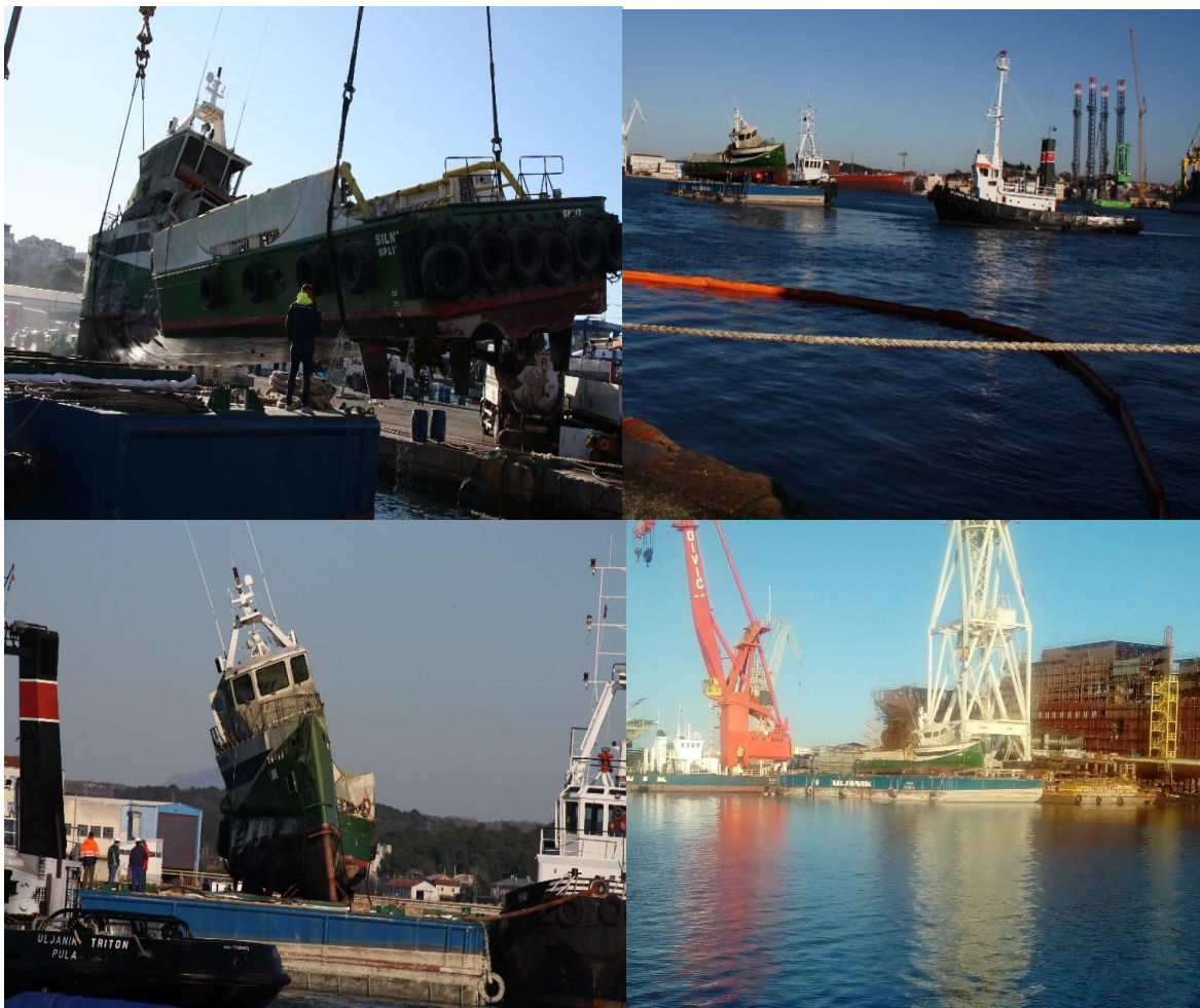
Slika 31. Polaganje na teglenicu, transport te polaganje broda „Silni“ na gat Galeb (izvor: LK Pula)
