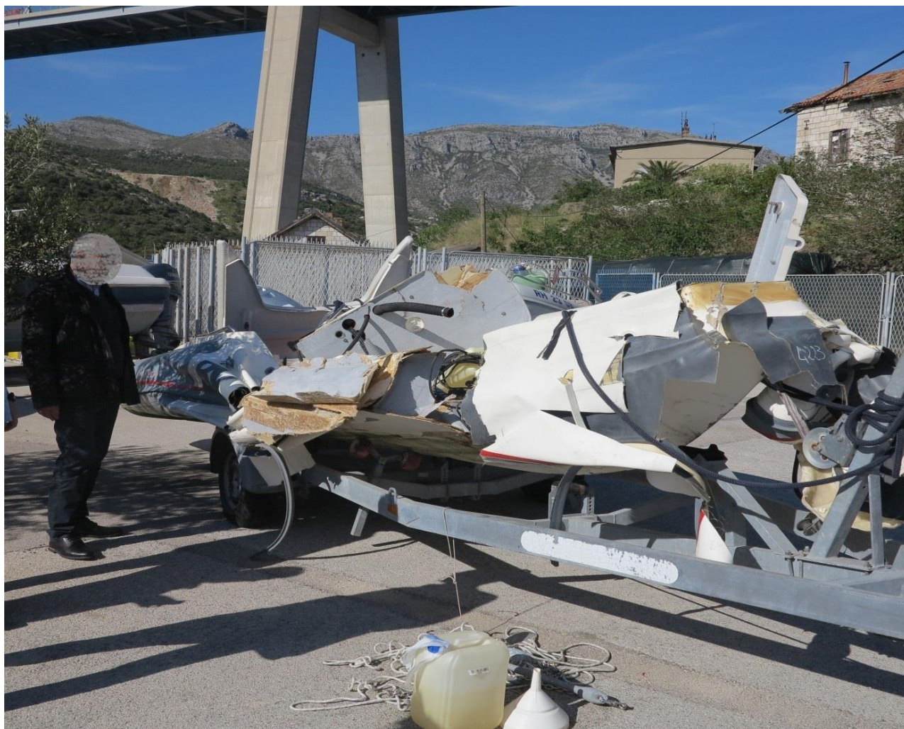
Slika 16. Vidljiva oštećenja brodice oznake „690 DB“, na suhom u luci Gruž nakon pomorske nesreće (izvor: Lučka kapetanija Dubrovnik)
