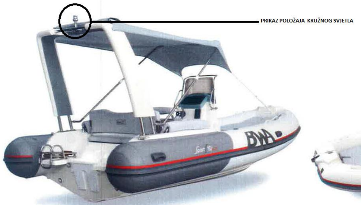
Slika 10. Prikaz položaja ugradnje bijelog kružnog svjetla (izvor: www.bwa.it )
