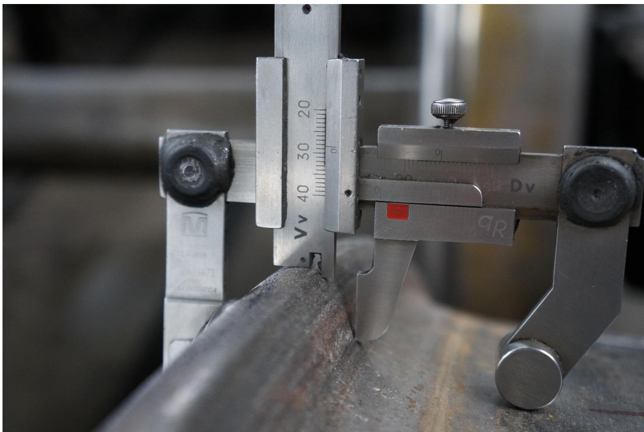
Slika 6. Mjerenje profila puknutog kotača (Izvor AIN)
