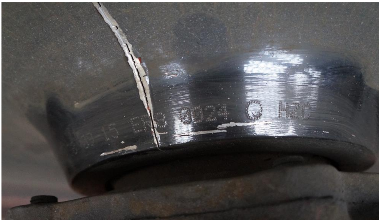
Slika 3. Oznake puknutog monoblok kotača (Izvor AIN)
