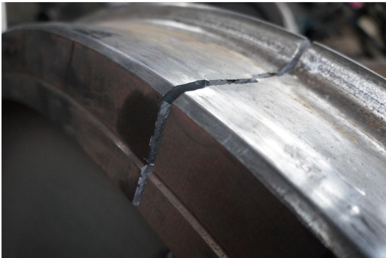
Slika 4. Bliži snimak mjesta inicijalne pukotine (Izvor AIN)
