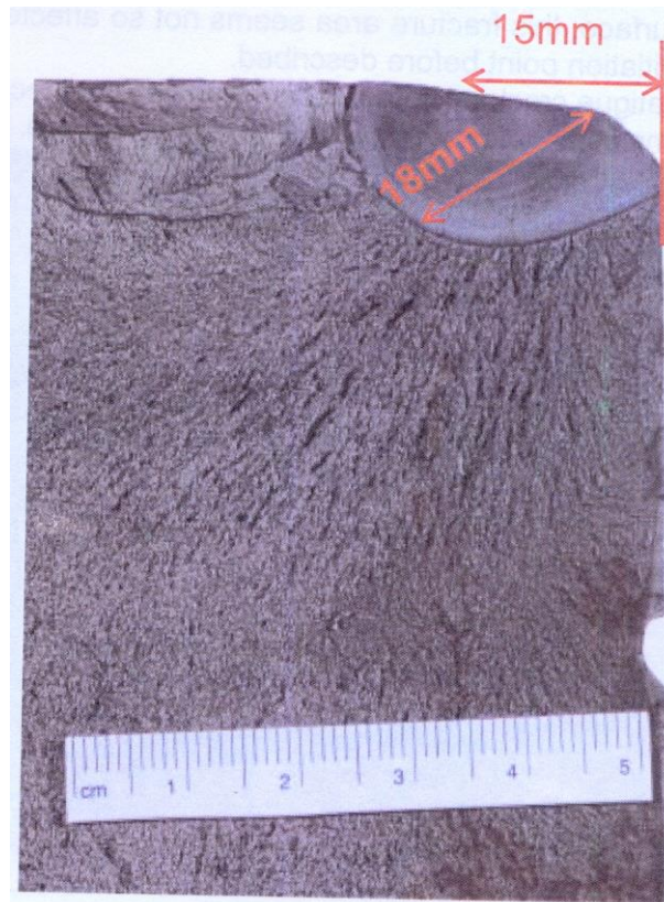
Slika 7. Mikroskopski snimak mjesta inicijalne pukotine (Izvor Lucchini)
