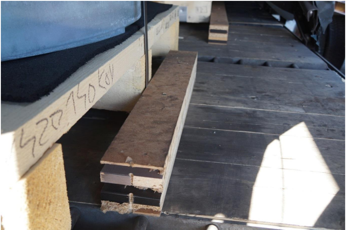
Slika 15. – Bliži snimak polomljene letve koja je osiguravala teret na vagonu (izvor slike: AIN)
