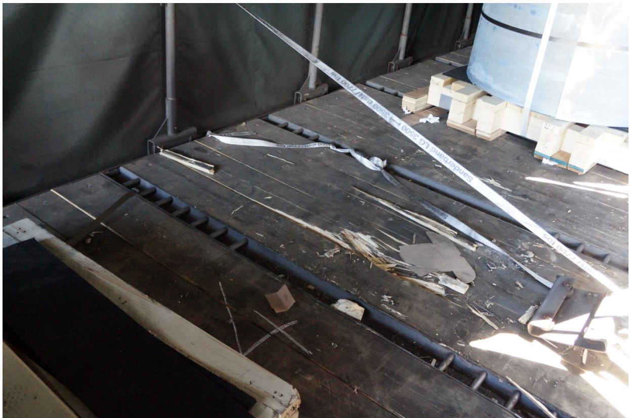
Slika 16. – Bliži snimak oštećenja podnice vagona (izvor slike: AIN)
