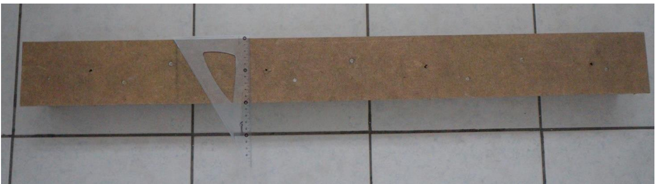
Slika 18. – Bliži snimak letvice za osiguranje paleta od pomicanja (izvor slike: AIN)
