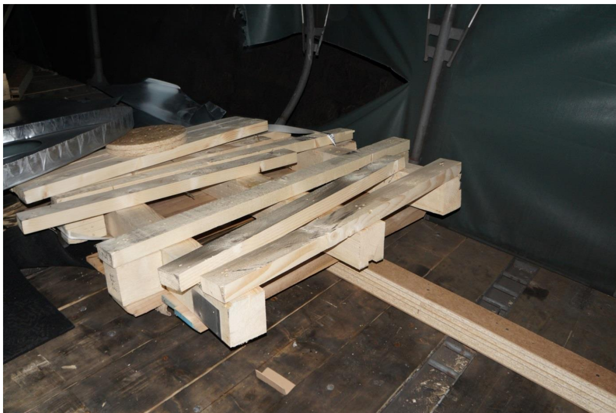
Slika 13. Detalj palete s tragom vezanja tereta na paleti (izvor slike: AIN)
