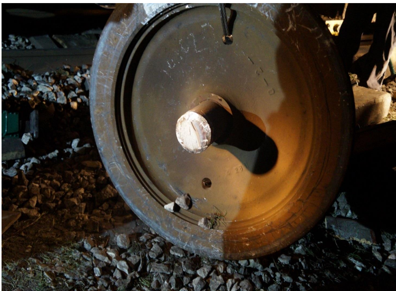
Slika 5. – Slika presjeka slomljenog vratila (izvor slike:AIN)
