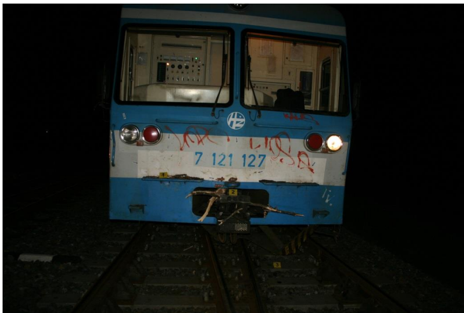
Slika 4 Slika oštećenog i iskliznulog DMV-a na ulazu u Beli Manastir (izvor slike: PP Beli Manastir)
