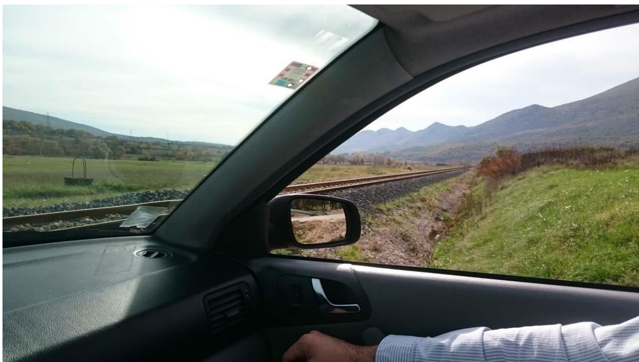
Slika 14. Preglednost na prugu prema smjeru Drniša s zapadnog privoza s pozicije pomaknutih prometnih znakova „STOP“ i „Andrijin križ“ (fotografirano 10. 11. 2015.)
