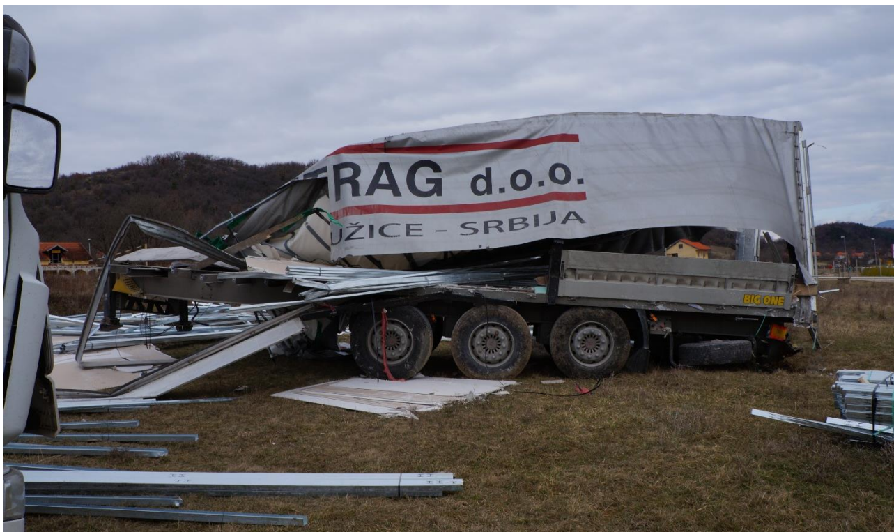
Slika 5 Oštećenja na priklučnom vozilu (Izvor AIN)
