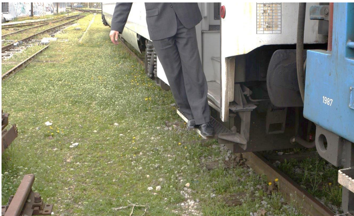
Slika 12. Detalj položaja stopala i potkoljenice manevarskog radnika na putničkom vagonu (Izvor AIN)
