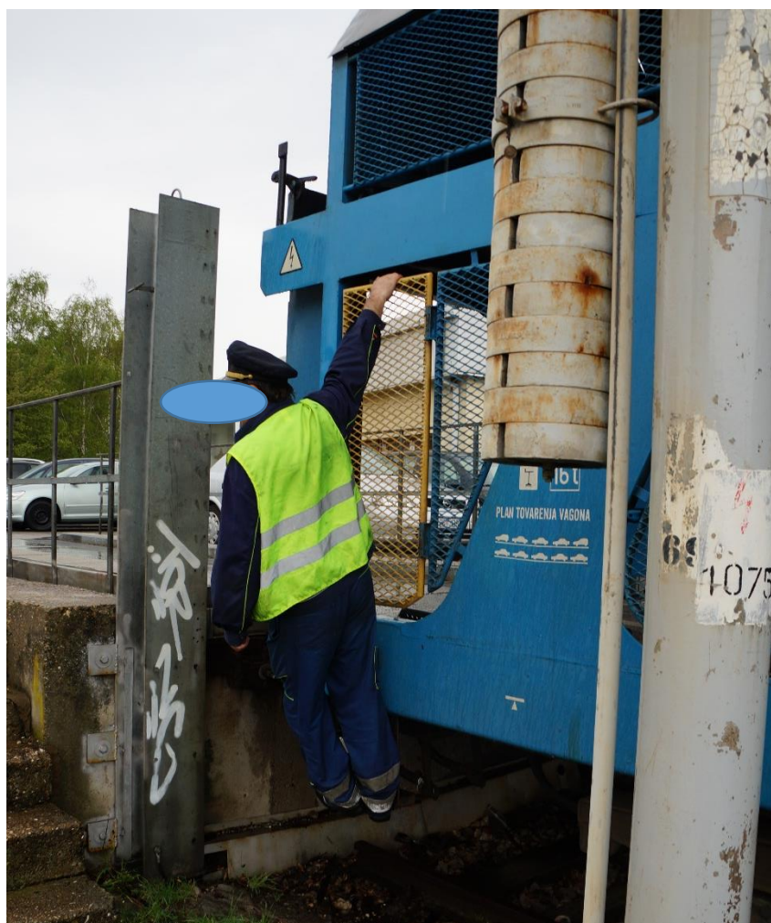
Slika 10. Prikaz položaja manevarskog radnika u kol. Zagreb GK na vagonu serije MDDIm (Izvor AIN)
