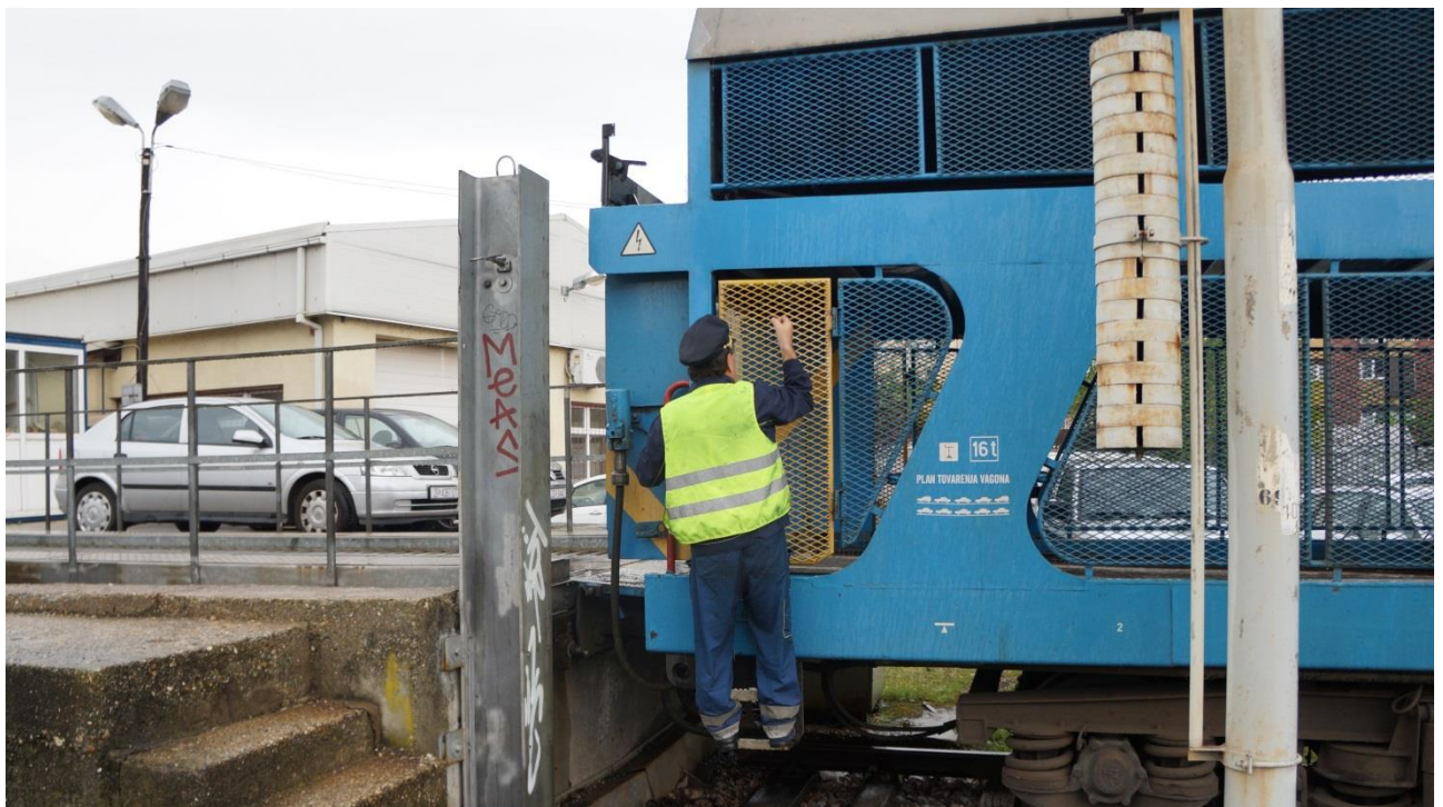
Slika 9. Prikaz položaja manevarskog radnika u kol. Zagreb GK na vagonu serije MDDIm (Izvor AIN).
