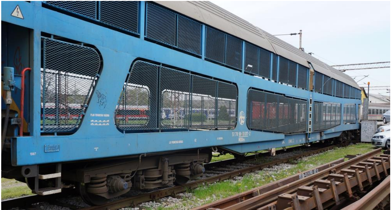
Slika 4. vagon za prijevoz automobila serije MDDIm (Izvor: AIN)
