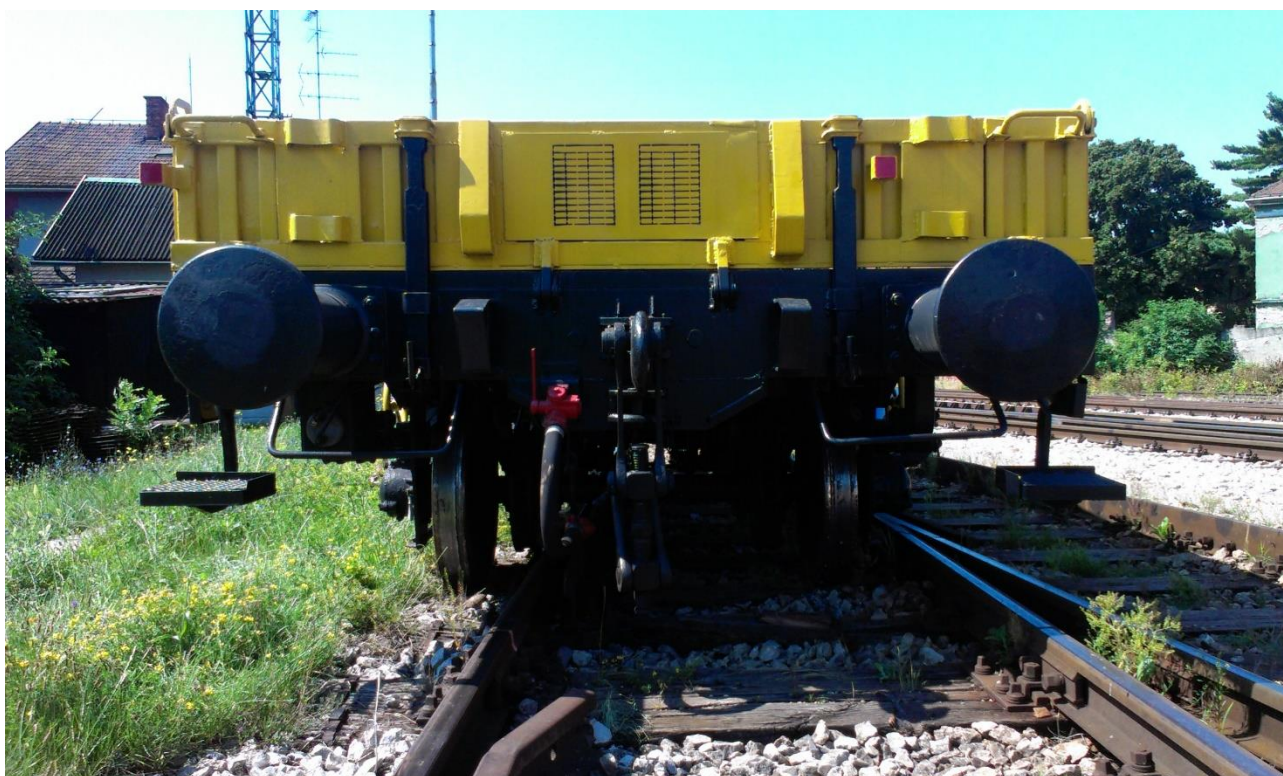
Slika 2 – položaj vagona nakon iskliznuća (izvor slike: AIN)
