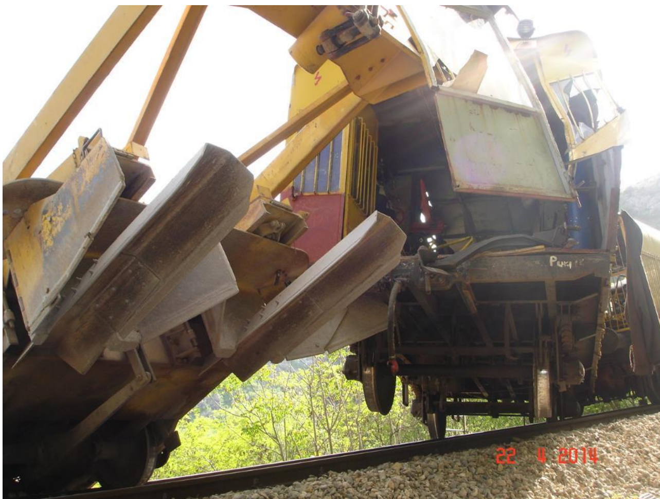
Slika 3 – Pozicija iskliznutih vozila nakon zaustavljanja (izvor slike: HŽ Infrastruktura d.o.o.)
