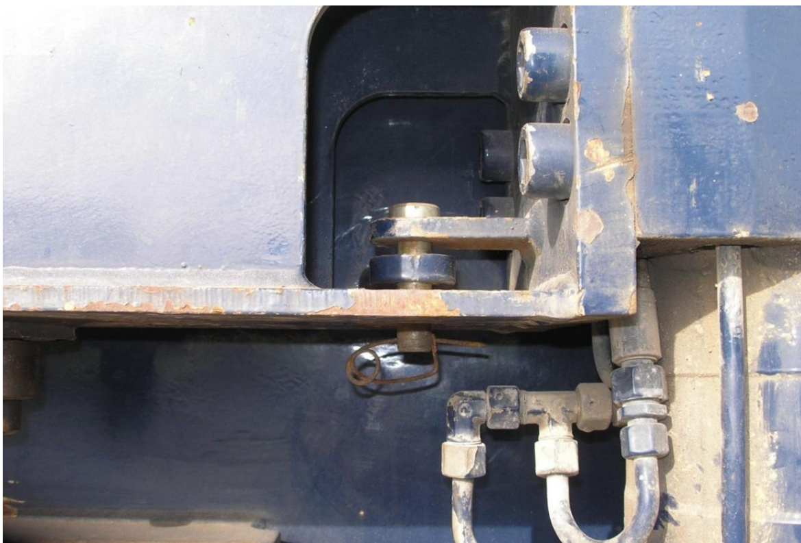
Slika 6 Stabilizator na desnoj strani tijela dizalice sa svornjakom (Izvor AIN)
