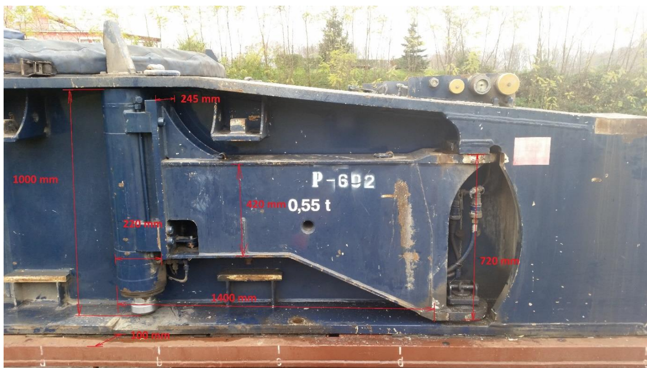
Slika 4 Ruka zadnjeg lijevog stabilizatora dizalice (Izvor AIN).
